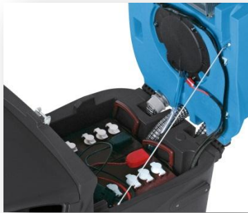
Koppla ur laddkabeln och stäng luckan till batteriladdaren
