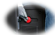
Maskinen är även utrustad med en knapp för nödstopp
